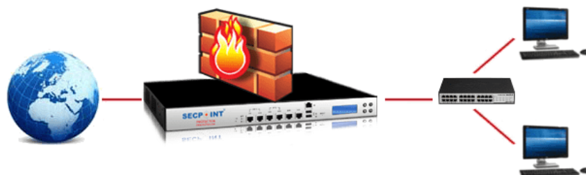
Slika 44: Požarni zid kot samostojna naprava
